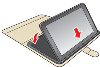
タブレットの上側を差し込んでから、下側を倒してはめ込みます。
